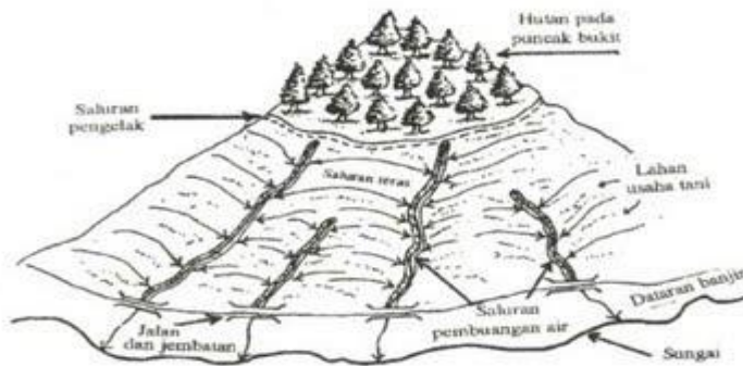
Letak saluran pengelak dan saluran pembuangan air pada suatu bukit (Sketsa: Agus dan Widiyanto)
